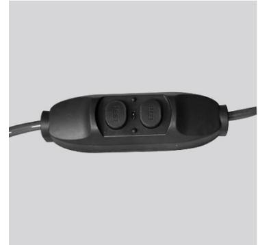
Ne placez ou ne mettez jamais le disjoncteur PRCD dans l'eau. Avant de commencer à travailler, vérifiez le bon fonctionnement en appuyant sur la touche TEST du disjoncteur PRCD. N'utilisez jamais l'appareil de carottage sans disjoncteur PRCD directement à partir de la source d'alimentation secteur.
